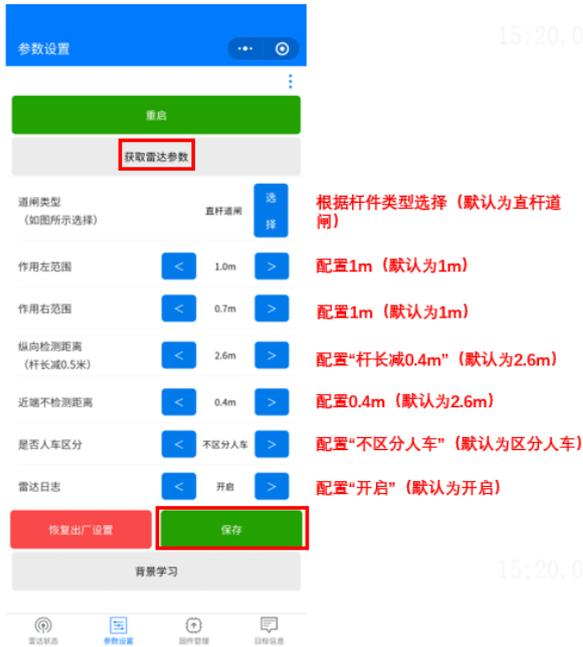
③ 杆件类型选择直杆道闸，并在右上角进入高级设置，设置直杆方向为左直杆（面向雷达，杆件在道闸的左边就是左直杆）
