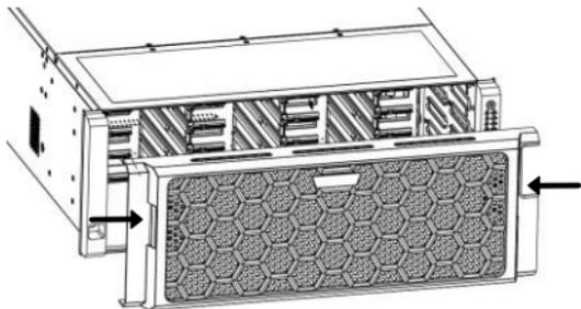
4. 对准硬盘槽位，轻缓、平稳地插入硬盘。听到“咔”的声响，则成功安装该硬盘。重复相同操作，安装剩余硬盘。
