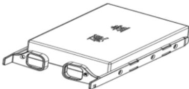
2. 用螺钉将硬盘固定在拉手条上。
