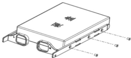
3. 双手分别按住前面板两侧卡扣按钮，两侧同时按压到底，向外移出，拆下前面板。
