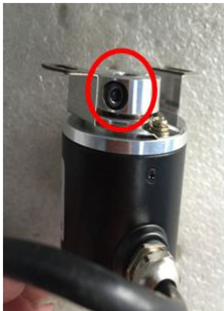
图2-1 编码器定位螺丝孔
