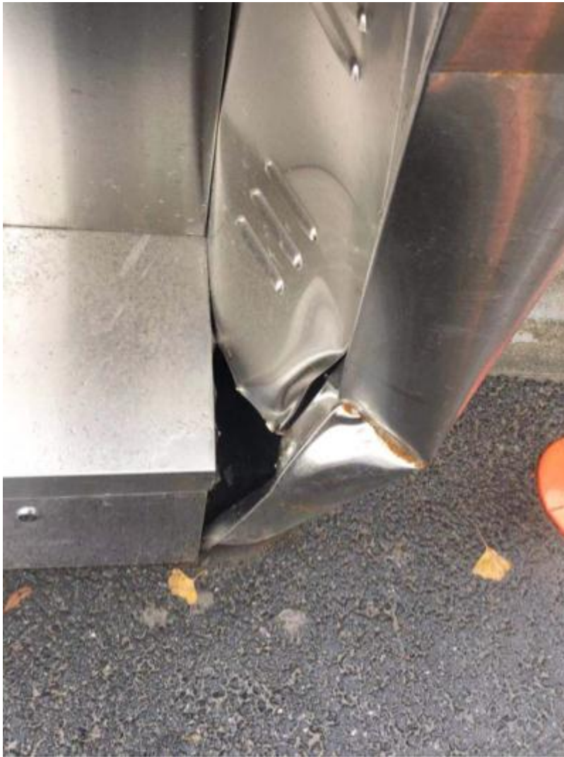
图3-1 闸机严重受损
